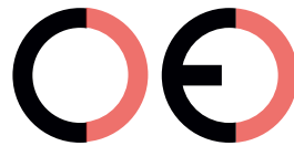
Falsche CE-Kennzeichnung (zu großer Zwischenraum)
