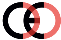
Falsche CE-Kennzeichnung (zu dicht)
